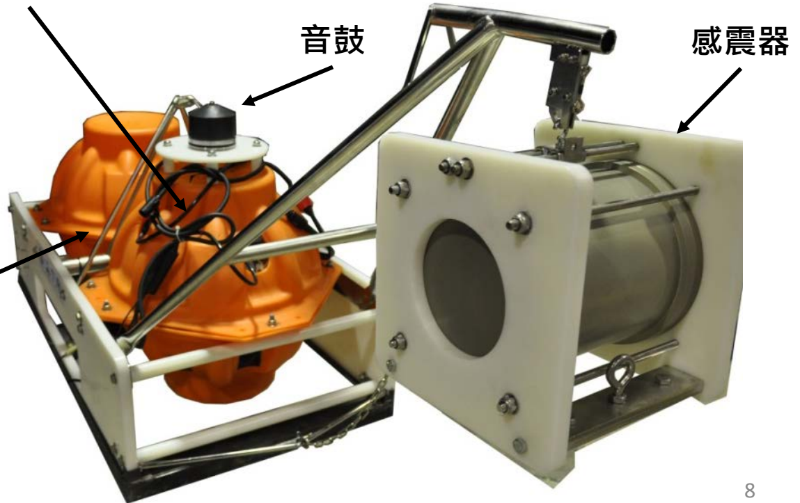
儀器球 - 內含系統電路板與電池
