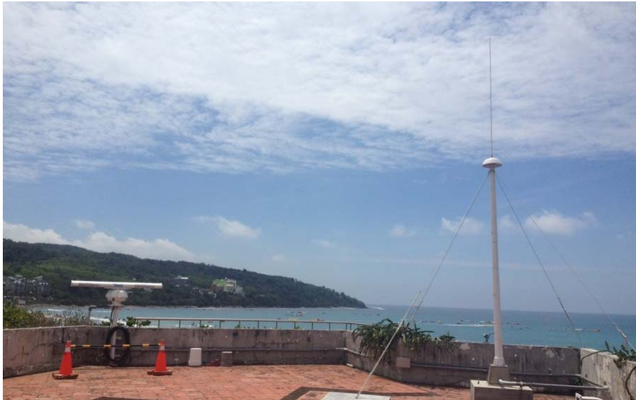
HF頻段與微波頻段海洋雷達波流觀測系統
